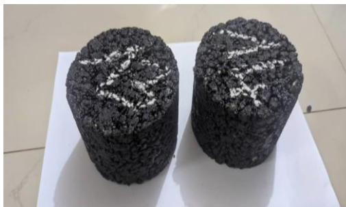
a-Éprouvettes de BBF soumises aux trois méthodes de cure (conservation)
