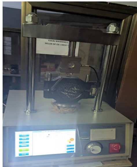
b-Éprouvette de BBF soumise à l'essai Marshall de résistance à la déformation
