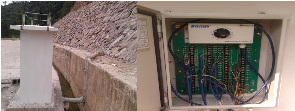
Fig. 08 : Les logettes et appareils enregistreurs des mouvements à la rive droite.
