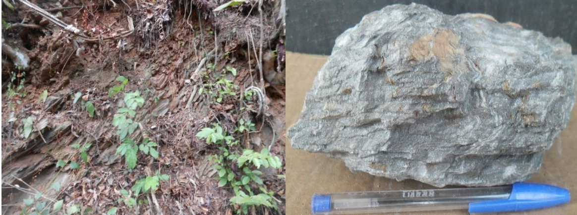
Photos13 : De gauche à droite : l'affleurement d'une roche et l'échantillon montrant un micro plissement perpendiculaire à la schistosité.
