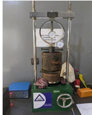
b-Dispositif de l'essai CBR
