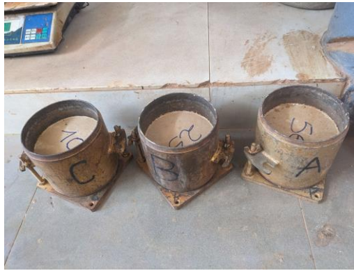
a-Conservation des éprouvettes CBR par immersion dans l'eau
