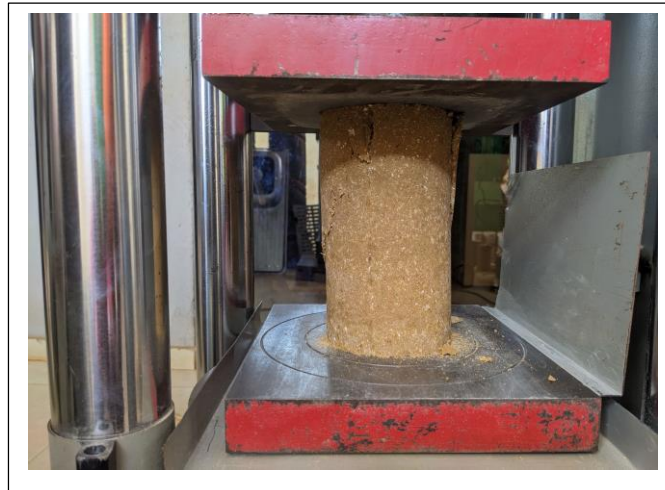
Figure 13 : Test de résistance en compression d'une éprouvette traitée au basemastic
