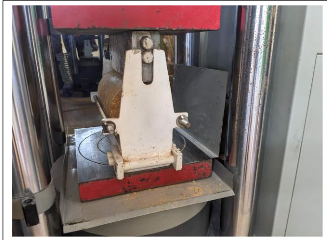
Figure 14 : Test de résistance en traction par fendage d'une éprouvette traitée au basemastic
