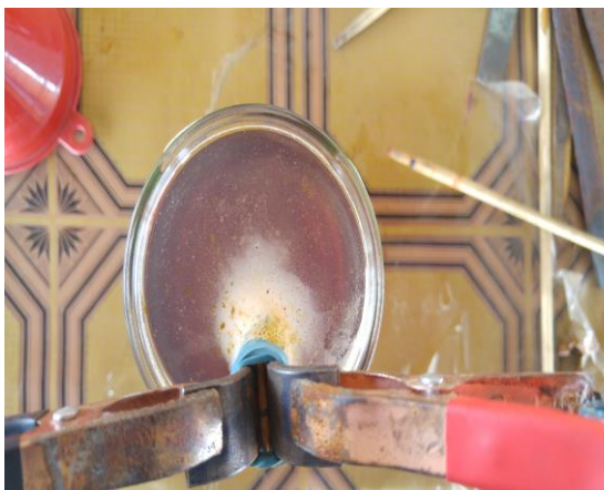
Figure 3 : Évolution visuelle des effluents (a : en pH très acide / b : en pH basique : Formation de floc verdâtre)
