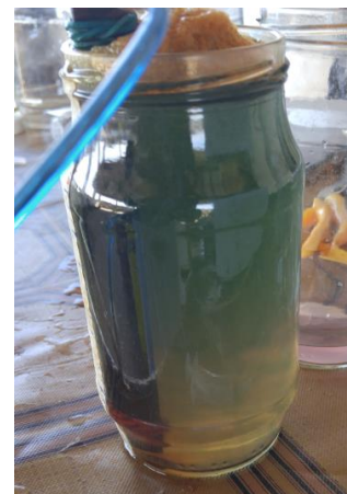
Figure 3 : Évolution visuelle des effluents (a : en pH très acide / b : en pH basique : Formation de floc verdâtre)
