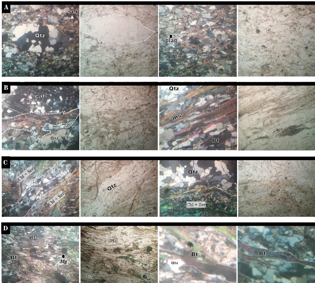
Figure 3 : Microphotographies des lithofaciès échantillonnés dans la zone d'étude (LPNA et LPA). (A) Quartzophyllade montrant des cristaux subautomorphes de quartz et de plagioclase, entourés de fines aiguilles de séricite. (B) Micaschiste présentant des porphyroblastes de calcite, associés à des cristaux de quartz et des feuillets de muscovite. (C) Chloritoschiste caractérisé par une alternance de niveaux lépidoblastiques riches en chlorite et séricite, et de niveaux granoblastiques constitués de quartz. (D) Biotitoschiste montrant la présence de biotite, de quartz et de calcite.
