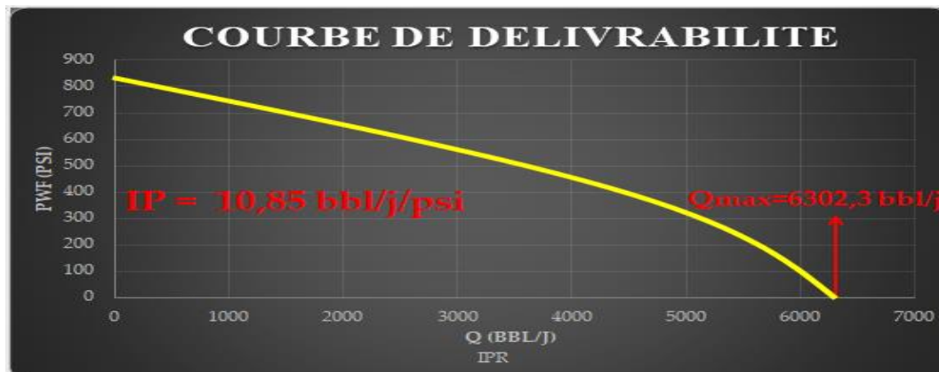
Figure 3. Courbe de délivrabilité de Mib-01X selon la loi de Vogel.
